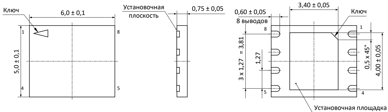
Рисунок 10 – Микросхема в корпусе DFN8 5×6×0,75 (1,27)
